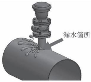
図1. 分岐部の漏水
