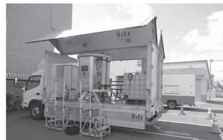
緊急用浄水装置として車載運用可能
